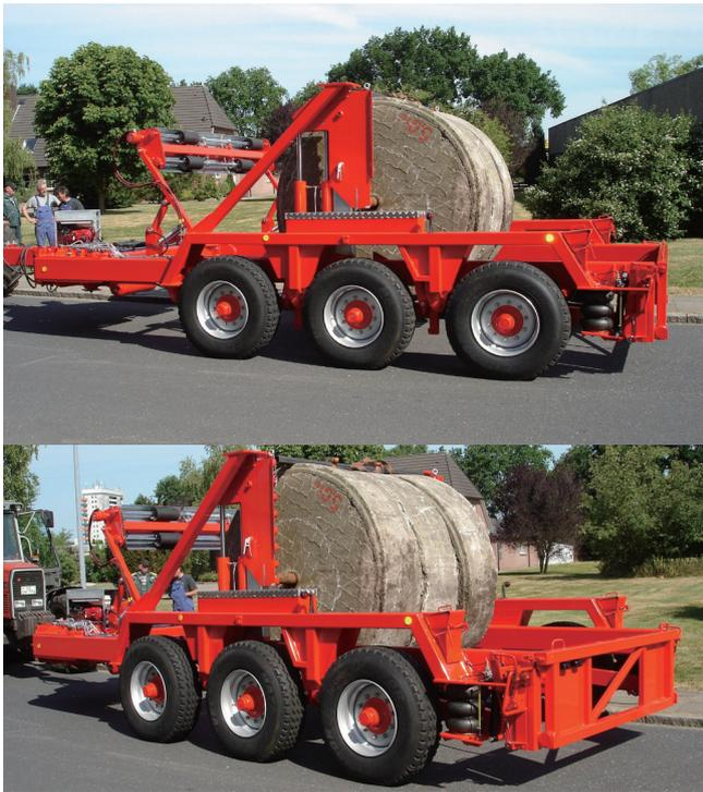
BTT300.15 拖车式电缆放线架
